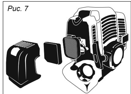
Фильтрующий элемент промывать теплой водой с мыльным раствором, запрещается применять для промывки растворители, бензин или другие огнеопасные вещества. После промывки тщательно отжать.
