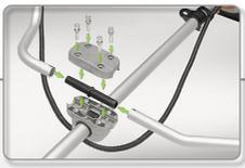
Увеличена жесткость крепления рукояток благодаря мощному кронштейну и дополнительной осевой вставке. Осевая вставка улучшает плотность зажима и исключает смещение рукояток относительно друг друга.
