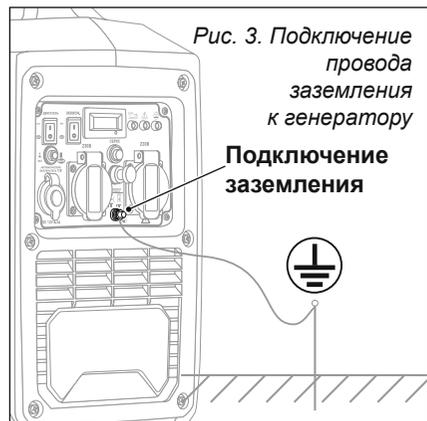
Рис. 3. Подключение провода заземления к генератору
