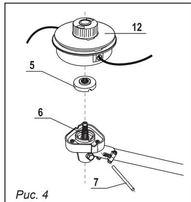
рядке. Выньте фиксирующий стержень 7. Снятие кассеты с леской производите в обратном порядке.
